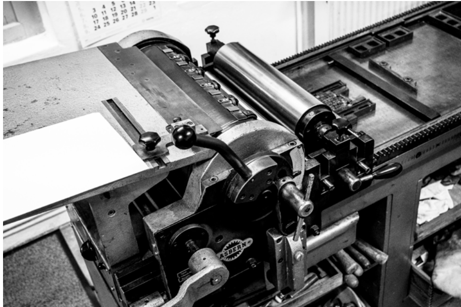
Abb. 20: Der Druckzylinder der Abziehpresse. Oben legt man das Papier ein und durch eine Rotationsbewegung wird das Papier über den Bleisatz gezogen und damit gedruckt.
