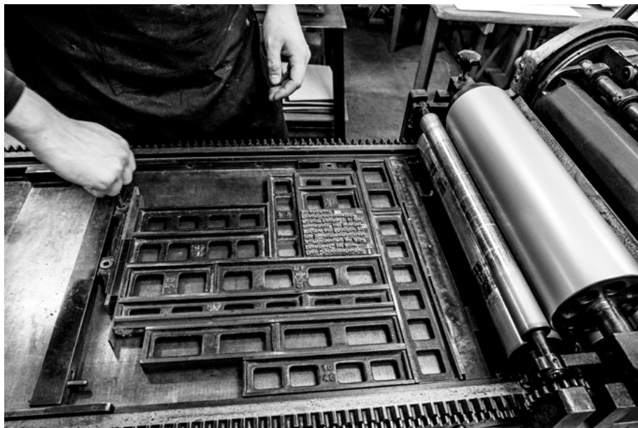
Abb. 30: Beim Arbeitsschritt des Form schließens. In diesem wird das Schließ-Zeug mit dem Form-Schlüssel handfest zu gedreht. Danach kontrolliert man, ob die Schrift in einer Zeile noch „wackelt“ oder alles fest sitzt. Dies ist wichtig, da lose Buchstaben beim Druckprozess heraus gehoben werden können und damit die Druckwalze beschädigen können.
