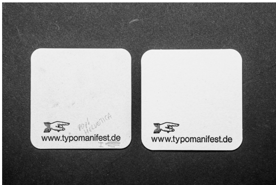
Abb. 31: Mit der Helvetica in 20pt sind die Bierdeckel händisch auf dem Boston Tiegel gedruckt. Man sieht wie der Buchstabe leicht in den Filz eingeprägt ist.
