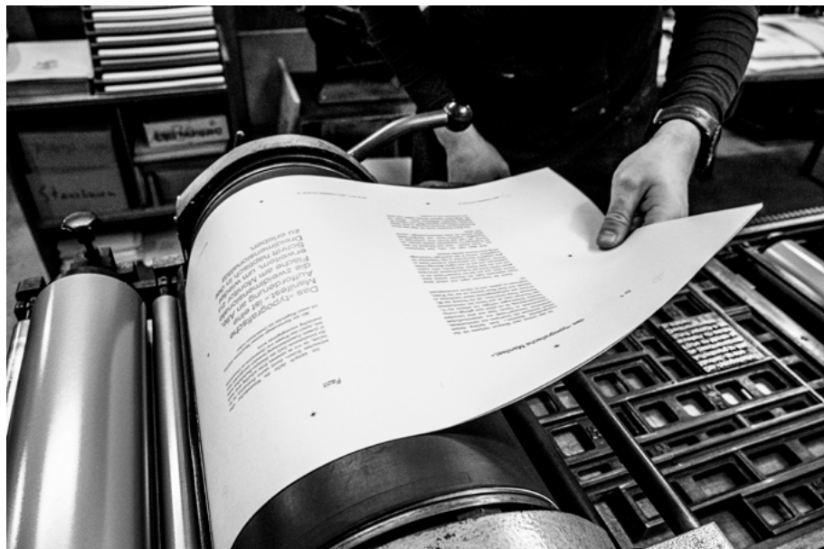
Abb. 28: Man sieht deutlich beim Druckprozess wie die Abziehpresse funktioniert. Zudem kann man im Detail erkennen, dass die Schrift spiegelverkehrt im Bleisatz gesetzt ist.
