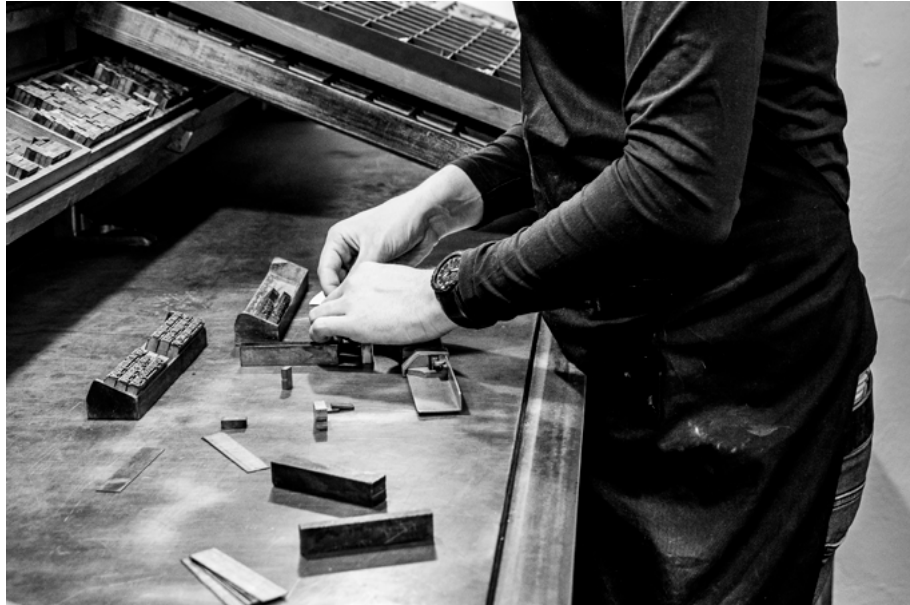
Abb. 26: Eine Seitenansicht bei der Arbeit im Bleisatz, welche der Veranschaulichung dient. In diesem Arbeitsschritt wird der Satz aus dem Winkelhaken mit Hilfe der Satzlinie in einen Hund gehoben.
